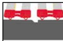
Motorischer Lattenrost mit schnurloser Fernbedienung ermöglicht eine unabhängige Einstellung des Kopf- und Fußteiles. Kappen am Seitenteil sorgen für doppelte Federung (Leisten und Kappen) in der gesamten Länge der Leisten, nicht nur im Mittelteil. Darüber hinaus verfügt Portoflex Motor Standard über eine MEMORY-Funktion, die die Speicherung einer Position in der Fernbedienung ermöglicht.
